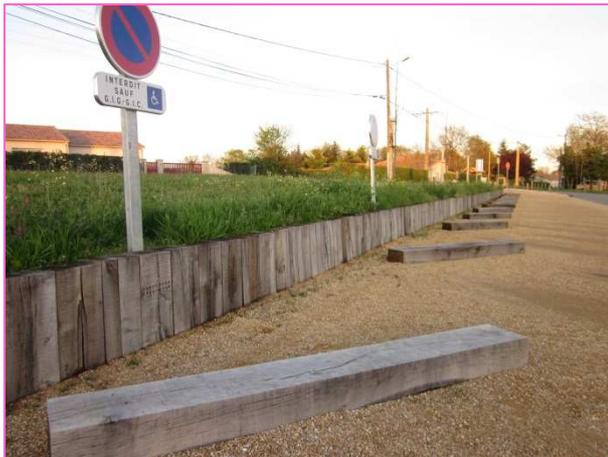
Dans le cadre de réflexions globales d'aménagements, ces éléments peuvent être remplacés par des bordures en pierre ou des traverses en bois.
