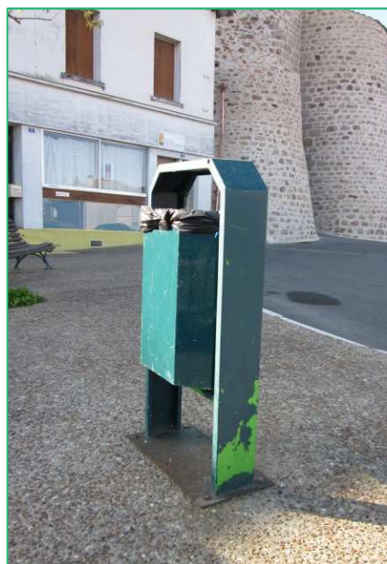
Poubelle en métal – Perte de couleur : Ternissement, décollement de la peinture
