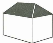
Quatre versants : Les toits à longs pans à croupes*, à demi-croupes, à longs pans brisés et croupes, en pavillon.
