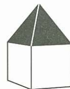
Quatre versants : Les toits à longs pans à croupes*, à demi-croupes, à longs pans brisés et croupes, en pavillon.
