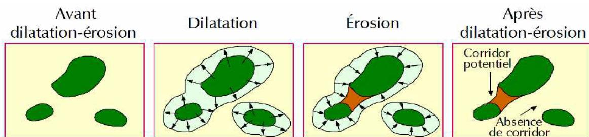
Cette érosion dilatation a été réalisée à l'aide d'un tampon de 1500 m pour simuler un déplacement maximal de 3 km.
